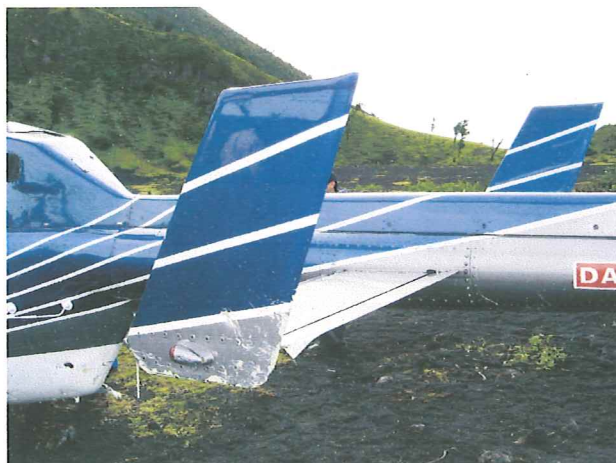
Daño en la parte inferior del estabilizador izquierdo.
