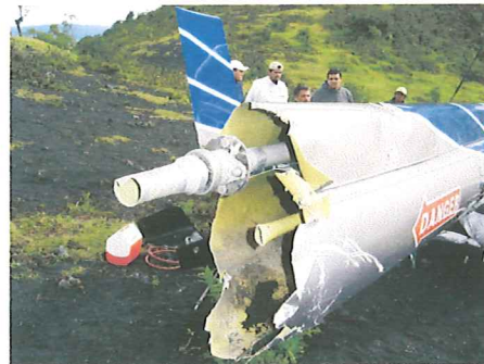
Perdida total del eje de la transmisión y del rotor de cola.
