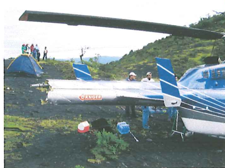
Perdida del rotor de cola y botalón por Impacto contra el terreno.
