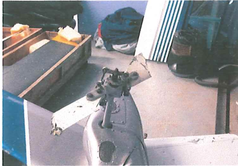
Perdida total de la caja de 90 y rotor de cola, por paro repentino.
