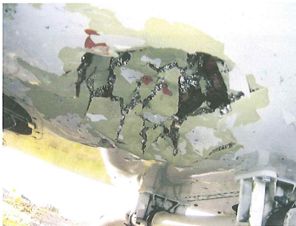
Daño sección inferior del fuselaje, área del tanque de Combustible, por Impacto directo contra las rocas.
