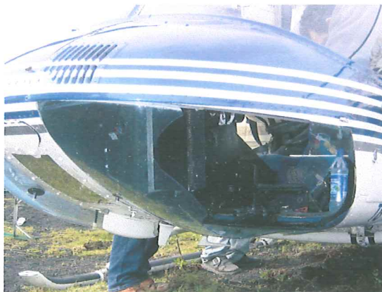
Perdida de las dos ventanas de Plexiglás Delanteras - inferiores, de la cabina.
