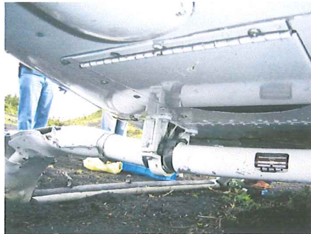
Daño en la estructura de soporte de los esquis o tren de aterrizaje por Aterrizaje brusco sobre piedras, daño en los cobertores de los esquis.
