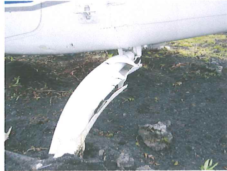
Daño en la estructura de soporte de los esquis o tren de aterrizaje por Aterrizaje brusco sobre piedras, daño en los cobertores de los esquis.
